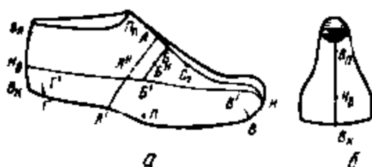
Рис. 5.3. Разметка колодки: а — вид сбоку; б — вид сверху
