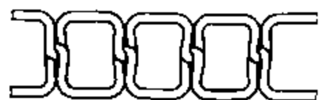
Рис. 19.1. Двухниточный стежок внутреннего переплетения
