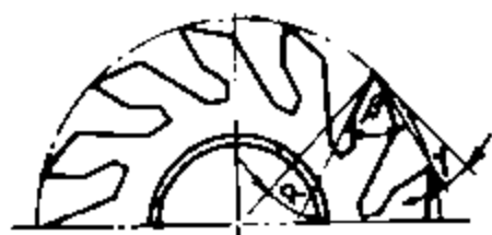
Рис. 32.1. Общий вид фрезы для обработки уреза деталей низа
