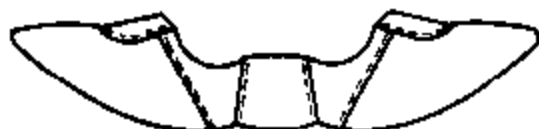
Рис. 21.13. Настрачивание заднего внутреннего ремня на кожаную подкладку
