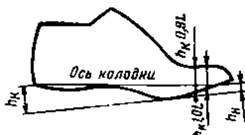
Рис. 4.6. Схема измерения высоты подъема пяточной и носочной частей колодки
