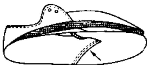
Рис. 21.18. Пристрачивание подкладки берцев к подкладке союзки
