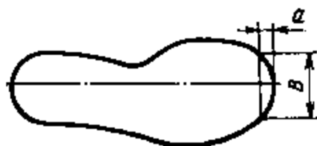
Рис. 4.7. Показатели, характеризующие форму носочной части колодки
