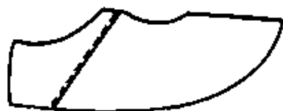
Рис. 21.12. Пристрачивание кожаной подкладки полуботинка к текстильной подкладке
