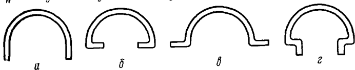
Рис. 7. Схемы формованных заготовок верха обуви с затяжной кромкой разных конфигураций
