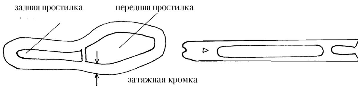
Простилка - заполняющая деталь для выравнивания неровности, возникшей на стельке после затяжки верха.
