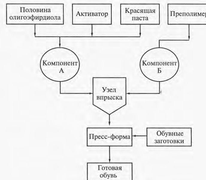
Рис. 6.16. Схема технологического процесса жидкого формования низа обуви
