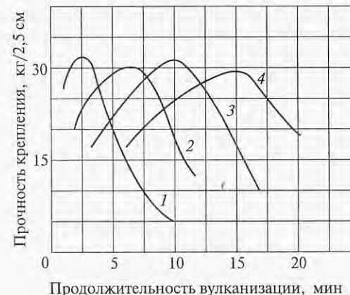
Рис. 5.6. Кривые зависимости прочности крепления от продолжительности вулканизации и толщины низа обуви: 1 — 3 мм; 2 — 6 мм; 3 — 9 мм; 4 — 12 мм
