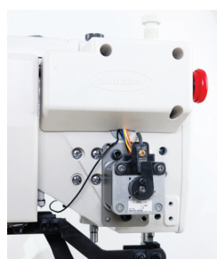
► Регулировка натяжения нити шаговым мотором
