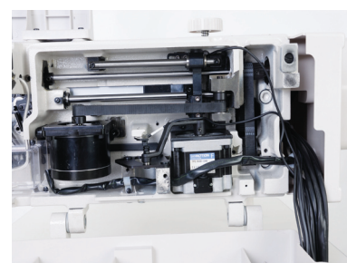
► Независимое функционирование приспособлений для обрезки нитей
