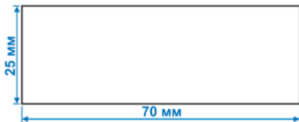
1. Полоска бумаги для проверки количества подаваемого масла в челнок
