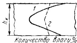
Рис. 4.5. Кривые распределения влаги по толщине кожи h_k после кратковременного погружения образца в воду:
