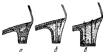
Рис. 6.24. Схемы крепления пластмассовых и деревянных каблучков
