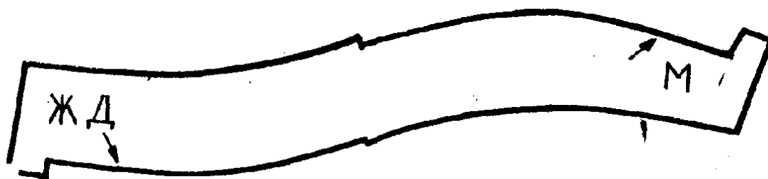
Рис. 50 Шаблон для проведения линии пяточного закругления
