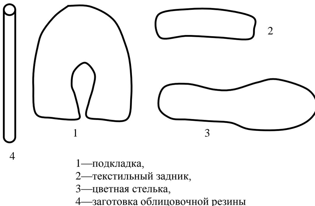
Рисунок 3.5— Детали штампованной галоши
