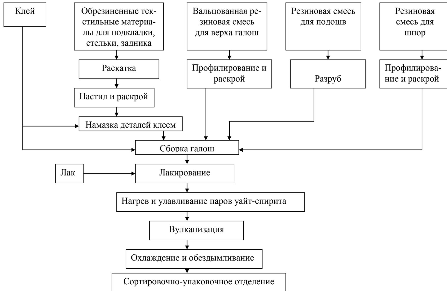
Рисунок 3.4—Схема производства галош методом клейки
