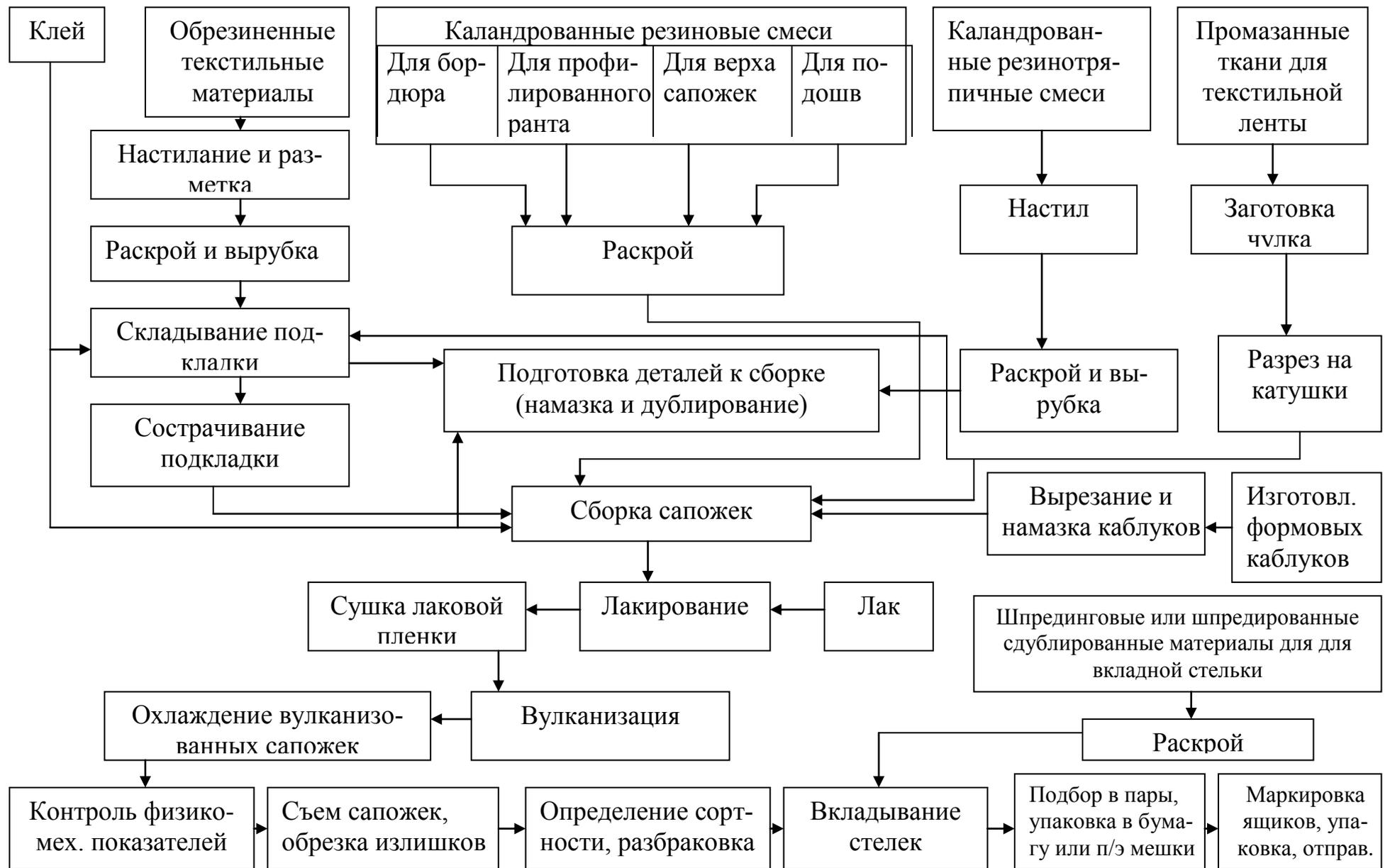
Рисунок 3.2—Схема производства сапожек методом клейки
