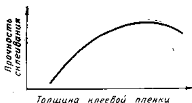
Рис. VII.15. Характер зависимости прочности склеивания пористых материалов от толщины клеевой пленки
