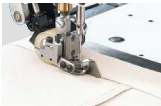
Durchsteppen von Rock- und Hosenbunden im Nahtschatten Stitching waistbands of skirts and trousers in seam shadow Притачивание корсажа в "тень" пояса брюк и юбок
