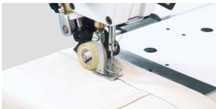
Durchsteppen des Bundes 1,6 mm rechts der Bundkante Stitching waistbands with a margin of 1,6 mm Отстрачивание пояса на 1,6 мм справа от иглы
