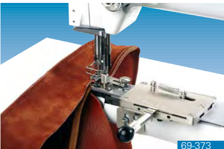
Näheinrichtung E21 und Kederführung N092 für das Einnähen eines Keders in einem bestimmten Nahtbereich
