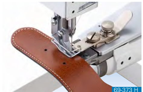
Näheinrichtung E107 mit Kantenschlag N800 für kantennahe Näharbeiten mit Hubbewegung des Untertransports für leichteren Nähguttransport
