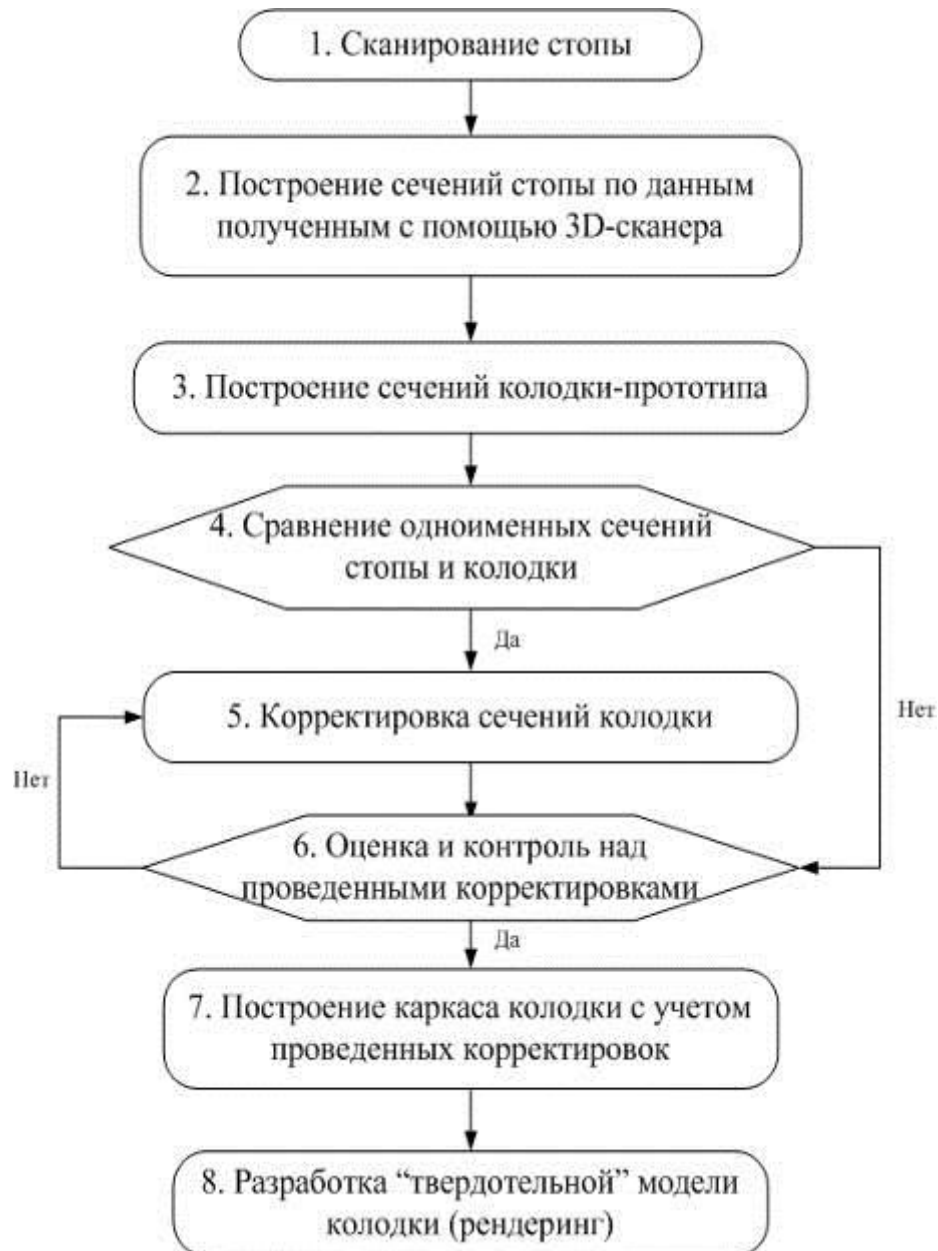
Рис. 3. Алгоритм технологии конструирования каркаса обувной колодки по данным о сечениях стоп
